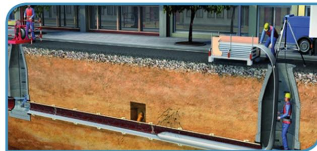
Technique du « chemisage » des réseaux d'assainissement, qui colmate les défaillances constatées par caméra optique.
